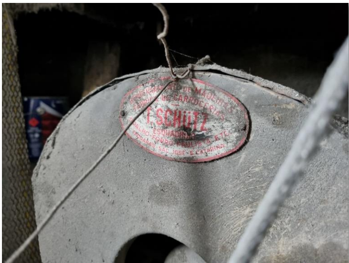
Fig. 17: Aspectos da ventoinha que alimenta a forja no sistema antigo de roldanas. Essa peça é proveniente da fábrica de Teófilo Schütz. Na peça consta: "Beneficiamento de madeiras; Fábrica de carrocerias; T. Schütz; Esquadrias; Soalho – Forro paulista ETC. Taquaras – São José – S. Catarina". 2023. (Acervo do Autor).
