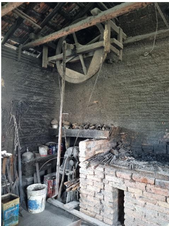
Fig. 13: Forja tocada à pé da ferraria de Valdevino Weiss. 2023. (Acervo do autor).
