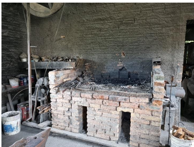
Fig. 18: Forja onde Valdevino esquentava as facas. À direita temos uma das "bocas" onde sai a chama, tocada à eletricidade, com um motor. À esquerda temos a antiga, com o sistema de roldanas. Ano 2023. (Acervo do Autor).
